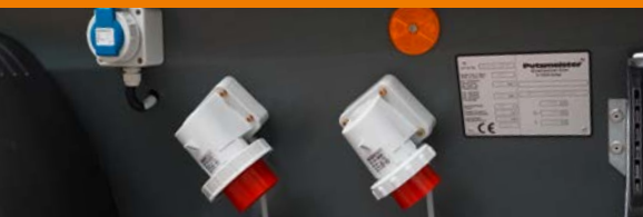
Standard 32-A-Steckdose und 16-A-Steckdose bei optionalem Zusatzaggregat
